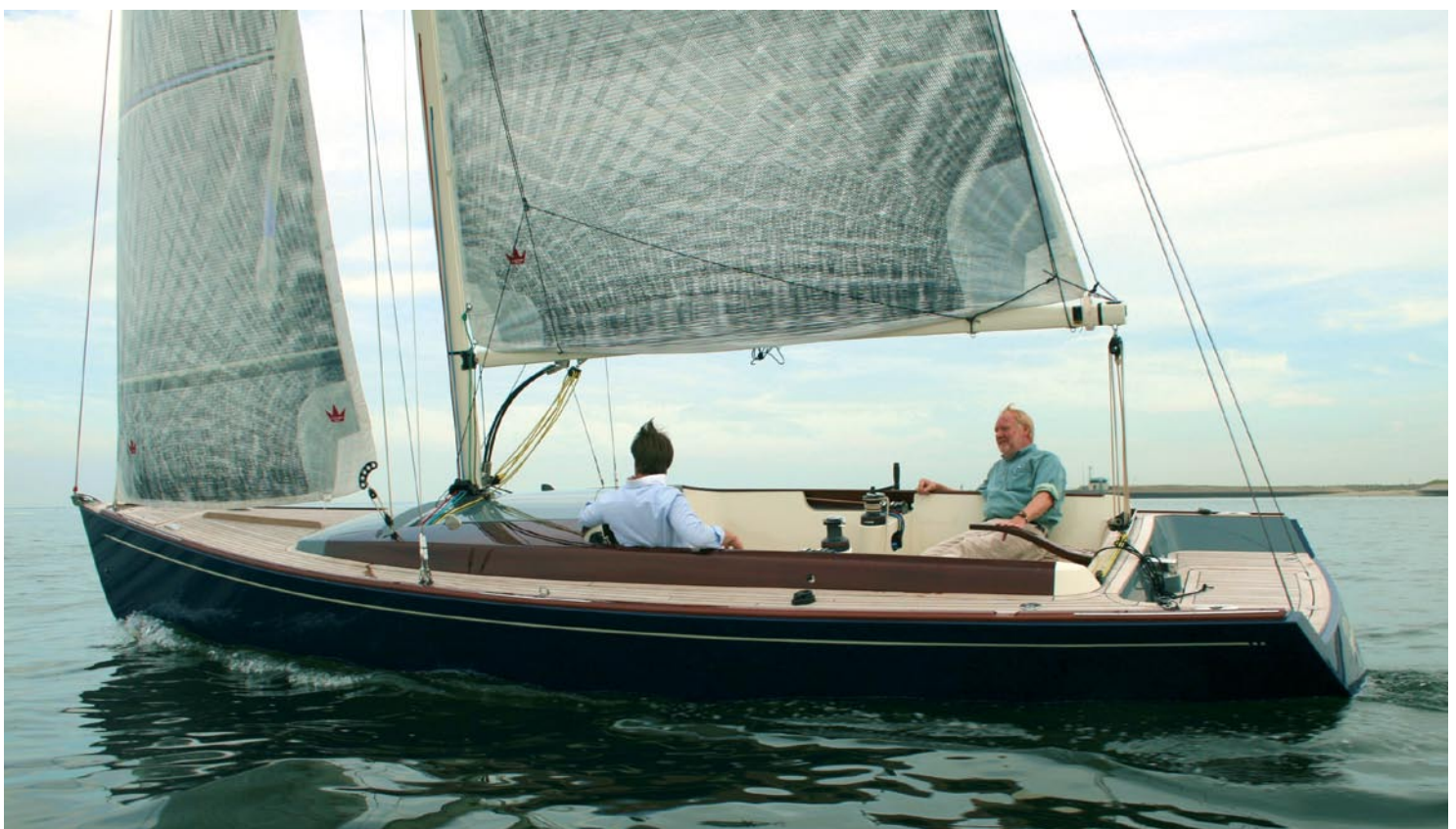
DE ROLLER VAN DE KEERFOK IS ONDERDEKS GEHOUDEN OM HET ZEIL ZO LAAG MOGELIJK AAN DEK TE VOEREN
